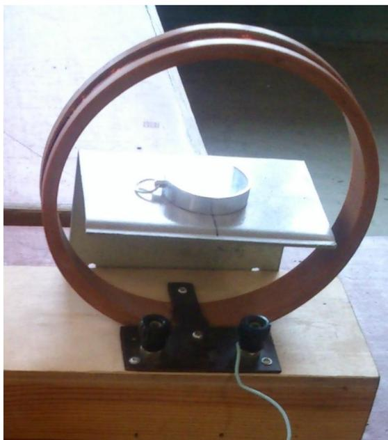
Рисунок 2. Тангенс-гальванометр.
