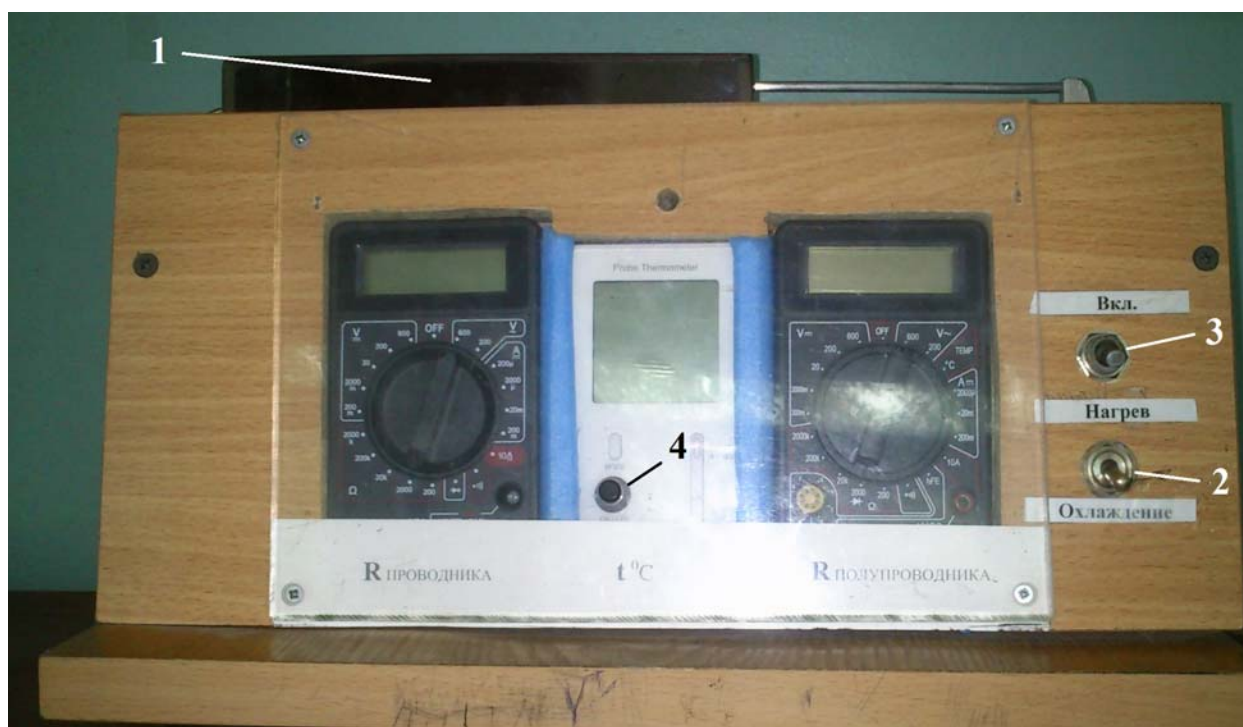
Рис. 3. Экспериментальная установка для измерения сопротивлений проводника и полупроводника.
